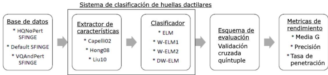
Figura 7: Esquema de la metodología donde se destaca el sistema de clasificación de huellas dactilares propuesto [1].
