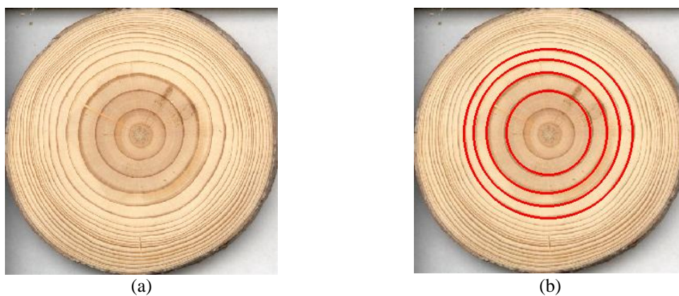
Figura 11. Algoritmo de localización de círculos sobre imágenes reales. (a) Muestra la imagen original, mientras que (b) presenta los círculos detectados superpuestos.
