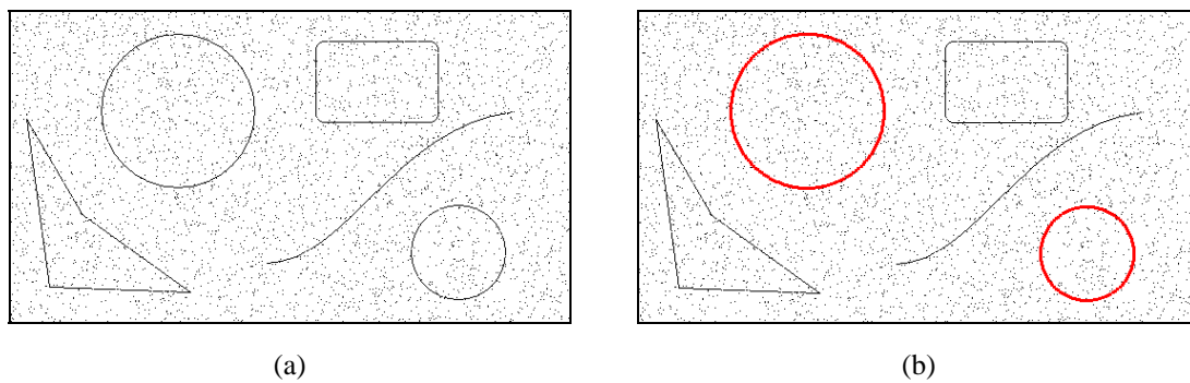
Figura 12. Discriminación de formas en imágenes reales. (a) Imagen original, (b) Círculos detectados superpuestos.
